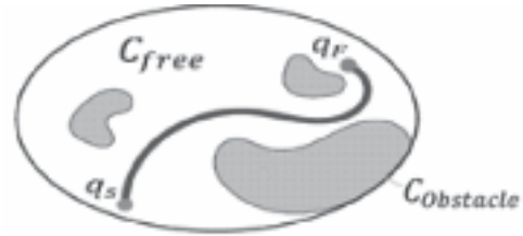
Hình 3. Miền không gian C_{free} chứa toàn bộ nghiệm góc khớp để vận hành từ điểm q_s tới q_f .
