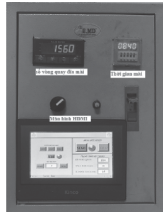
Hình 4. Tủ cài đặt và hiển thị chế độ kiểm tra thử mòn
