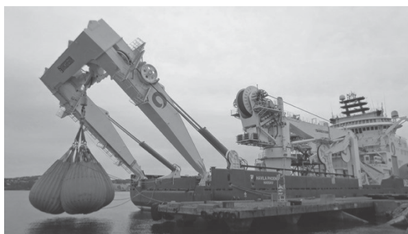
Hình 2. Kết cấu dạng khung cầu chữ A
