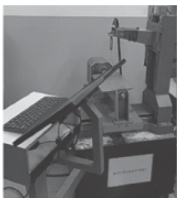
Hình 3. Hệ thống WAAM CNC 4 trục
