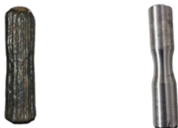
Hình 4. Mẫu thử sau khi chế tạo và gia công đúng tiêu chuẩn
