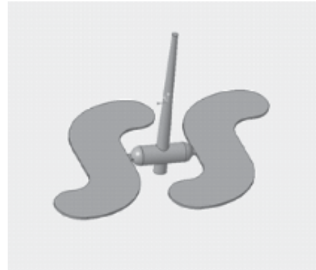
Hình 2. Mô phỏng phun ép sản phẩm
