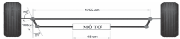
Hình 4. Kết cấu hệ thống dẫn động lái cầu sau
