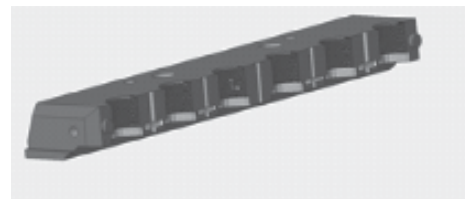
Hình 2. Con trượt để tạo ren ngoài
