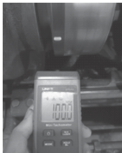
Hình 7. Đồng hồ đo tốc độ quay của máy tiện
