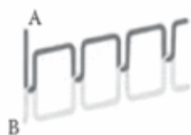
Hình 1. Đường may sử dụng mũi thoi 301 [6]
