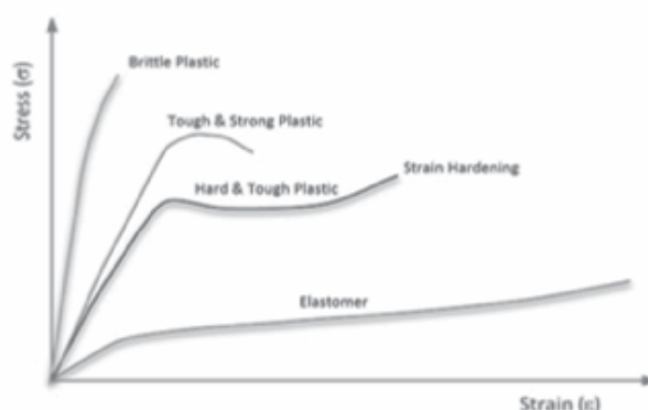
Hình 2. Đồ thị ứng suất-biến dạng các loại polyme
