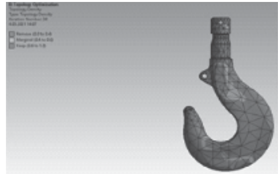
Hình 3. Tối ưu hóa cấu trúc liên kết của móc nâng
