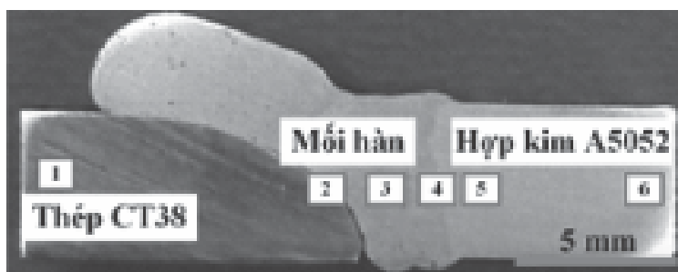
Hình 1. Cấu trúc thô đại liên kết hàn giáp mối giữa thép CT38 và hợp kim nhôm A5052 bằng quá trình hàn GMAW
