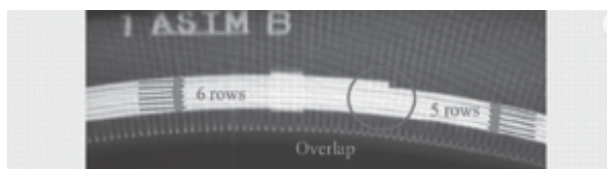
Hình 2.8. Sử dụng tia X để quét cấu trúc lốp
