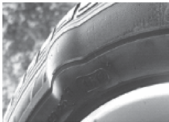
Hình 2.1. Lốp xe bị phồng
