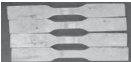
Hình 4. Mẫu sau khi chuẩn bị đưa vào kéo
