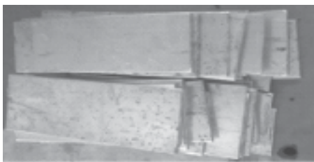
Hình 3. Nhôm tấm A5052 dùng thí nghiệm
