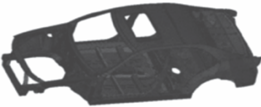
Hình 2. Mô hình phần tử hữu hạn khung vỏ ô tô sau khi tạo liên kết
