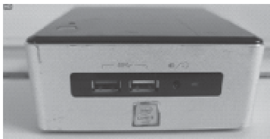
Hình 3. Máy Intel Nuc dùng làm máy chủ hệ thống chẩn đoán truy cập từ xa
