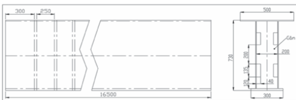
Hình 2. Kích thước của dầm cầu trục
