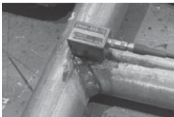
Hình 1.2. Vị trí đặt đầu dò để siêu âm
