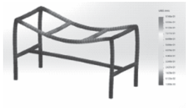
Hình 6. Kết quả mô phỏng chuyển vị của hệ khung đỡ
