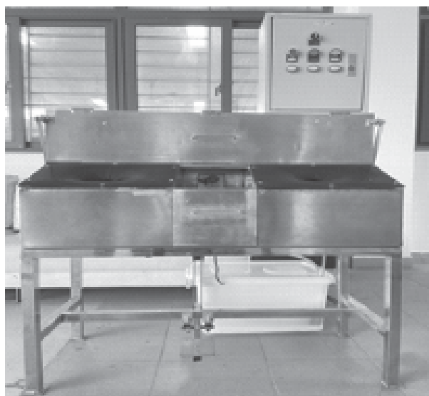
Hình 10. Hệ thống tích hợp khử khuẩn đồ dùng cá nhân nơi công cộng đang được thử nghiệm tại Đại học Bách Khoa Hà Nội
