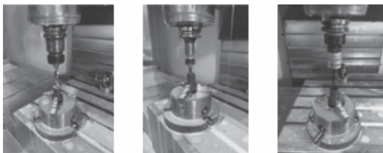
(a) Quá trình khoan (b) Quá trình phay (c) Quá trình lăn ép Hình 1. Quá trình phay-lăn ép kết hợp.
