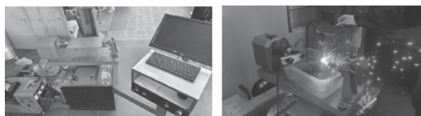
Hình 4. Mô hình máy hàn MIG WAAM 4 trục
