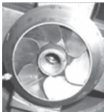
e. Kiểm tra độ tròn, khả năng chịu momen xoắn cánh bơm sau hàn
