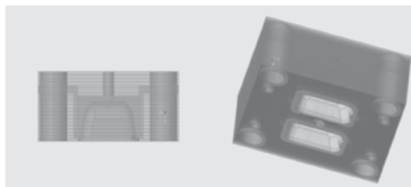
Hình 4. Tấm khuôn âm sản phẩm 3D cắt lớp
