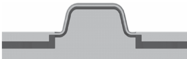
Hình 10: Kênh giải nhiệt hình 3D ở tấm khuôn dương
