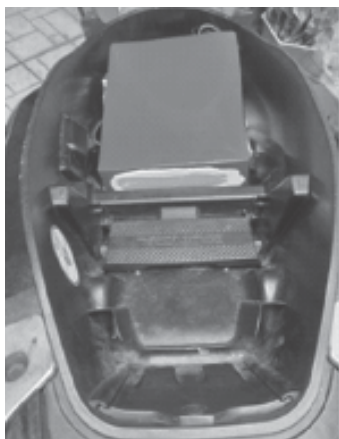
Hình 2. Bố trí mạch điều khiển và bộ pin 60V-20Ah trong cốp xe AirBlade.
