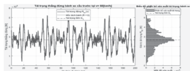
Hình 9. Tải trọng thẳng đứng tại bánh xe cầu trước khi v = 60 km/h
