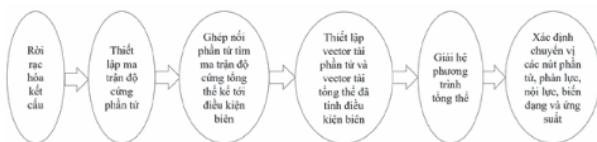
Hình 5. Các bước giải bài toán phần tử dầm bằng phương pháp PTHH.
