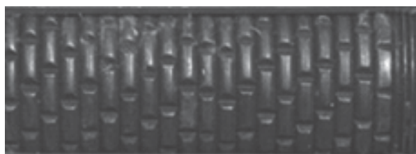
Hình 1. Ống tạo mảnh của đạn DLP-17
