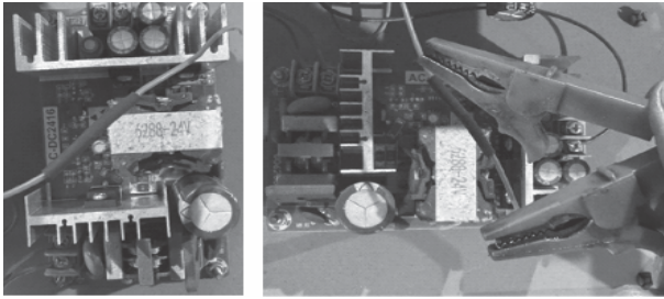
Hình 5. “Chế” mạch điều khiển kim phun có thông số tương tự tín hiệu điều khiển kim phun từ ECU. Hộp có thể chạy thử cho cả nguồn điều khiển 12V và 24V
