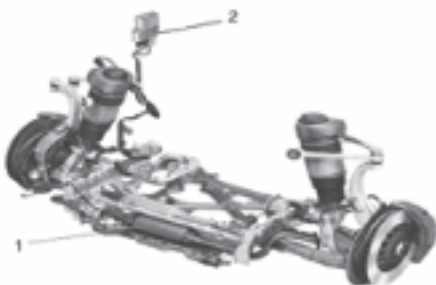
Hình 2. Hệ thống treo sử dụng hệ thống ổn định ngang chủ động:
