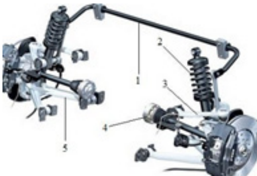
Hình 1. Hệ thống treo sử dụng thanh ổn định ngang bị động:
