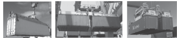
Hình 2.2. Cần trục QC, STS làm hàng [4]: H.a - Loại 1 cơ cấu nâng chính nâng 1 container, H.b & H.c - Loại nâng nhiều container dùng cơ cấu kẹp
