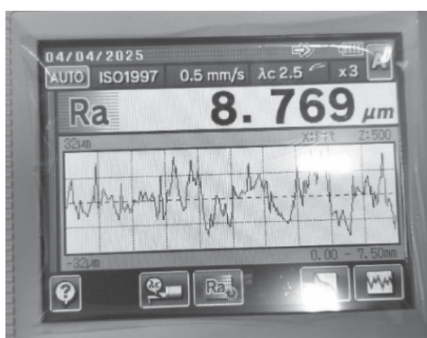
Mẫu in kết quả của phép đo độ nhám Hình 4. Các bước tiến hành thực nghiệm
