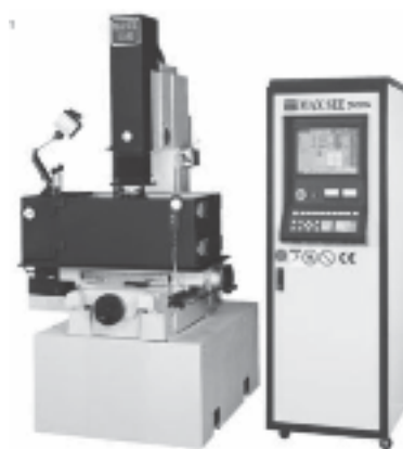
Hình 1. Máy xung định hình CNC (P26-E30) – MAXSEE (Đài Loan)
