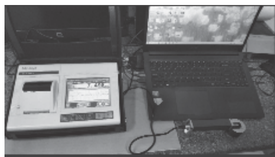
Hình 3. Máy đo độ nhám Mitutoyo SJ-310 Nhật Bản
