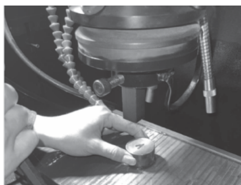
Gá đặt phôi làm thí nghiệm
