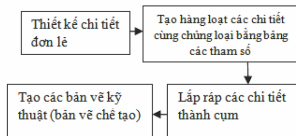
Hình 4. Trình tự thiết kế máy ép bánh
