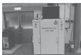
Hình 1. Nguồn hàn và đầu in laser 3D Ytterbium Fiber Laser YLR-5000W.
