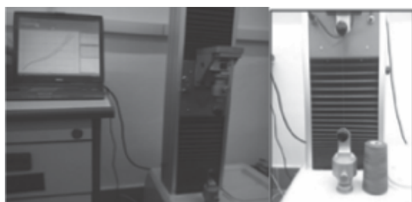
Hình 2. Thực nghiệm kéo đứt chỉ
