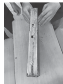
Hình 3. Mối hàn sau khi hàn đắp các tấm
