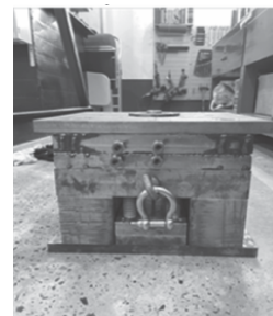
Hình 5. Hình ảnh bộ khuôn hoàn chỉnh
