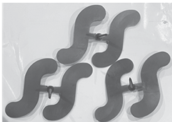
Hình 6. Sản phẩm nhựa dạng 2D sau khi ép thử
