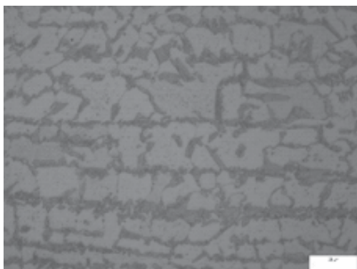
Hình 3. Cấu trúc tế vi khu vực số 1 trong Hình 2
