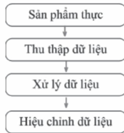
Hình 1. Quy trình thiết kế ma-nơ-canh từ dữ liệu quét 3D
