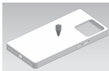
Hình 1. Pin Point Gate đặt tại trung tâm mặt đúc
