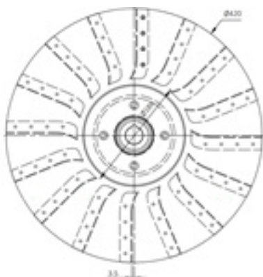
Hình 7. Cánh quạt hoàn thiện
