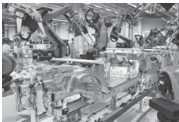
Hình 1. Thành phần tay máy robot đóng vai trò tự động hóa trong dây chuyền sản xuất lắp ráp ô tô
