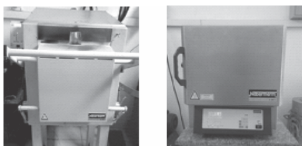
a) b) Hình 2. Lò nhiệt luyện tôi (a) và ram (b) của hãng Nabertherm.
