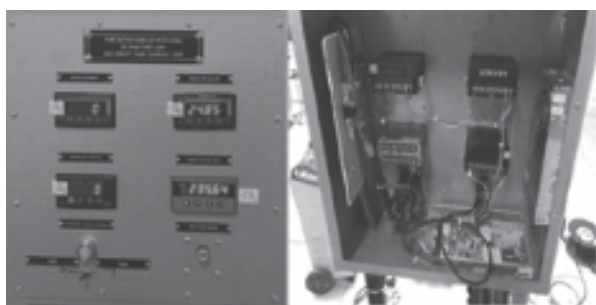
Hình 3. Bảng táp lô các thông số khi thử nghiệm động cơ điện khởi động
