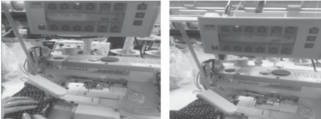
Hình 2. Điều chỉnh lực căng chun (F1 tại 3 cung) trên bảng điều khiển máy may trần đề
