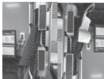
Hình 6. Thiết bị kéo giãn đứt đường may theo các phương án thí nghiệm
