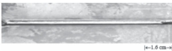
a) Mẫu 4-1, \alpha = 30^\circ , b_0 = 0.5 \text{ mm} , hàn 1 lớp, C_p = 50\% , P = 1.4 \text{ kW} , v_h = 25.2 \text{ cm/ph}
