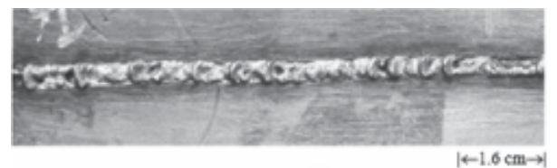
b) Mẫu hàn 3 lớp, \alpha = 10^\circ , b_0 = 0.1 \text{ mm} , P = 1.5 \text{ kW} , v_h \approx 10.0 \text{ cm/ph} , C_q = 30 \%
