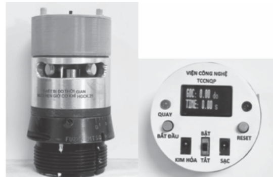
Hình 7. Thiết bị đo thời gian hẹn giờ thiết bị hẹn giờ gây nổ cơ khí HGCK.21 qua chế tạo
