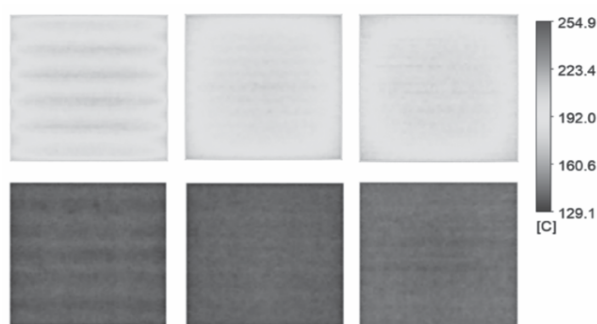
Hình 4. Trường nhiệt độ tại thời gian 17 s; hàng trên là nhiệt độ bề mặt trên, hàng dưới là nhiệt độ mặt dưới của tấm. Bên trái với a = 40 mm; giữa b = 60 mm; phải a = 100 mm.
