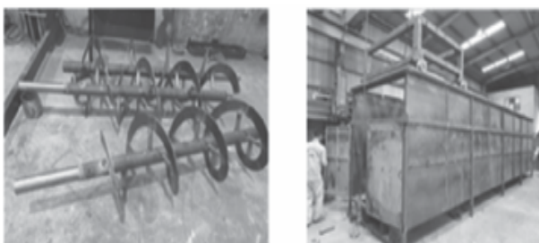
Hình 6. Hình ảnh kết quả chế tạo thân buồng ủ và cụm thiết bị đảo liệu [1]
