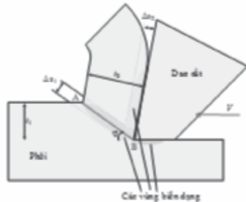
Hình 1. Các vùng biến dạng được giả định trong mô hình vùng cắt trượt của Oxley
