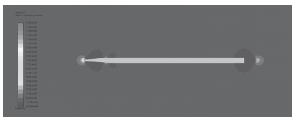
Hình 4. Trường áp suất tại trường hợp vận tốc đạn 50 m/s
